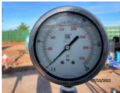
รูปที่ 2-35 การปรับลดแรงดันจากการทดสอบท่อด้วยวิธี Hydrostatic Test
