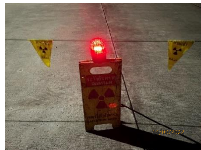
รูปที่ 2-61 การกันเขต และติดป้ายแสดงเขตหวงห้าม บริเวณพื้นที่ที่ทำการตรวจสอบรอยเชื่อม
