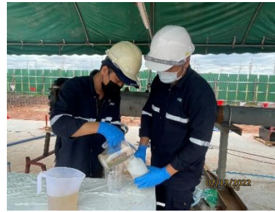
รูปที่ 2-33 การติดตามตรวจสอบคุณภาพน้ำทิ้งจากการทดสอบท่อด้วยวิธี Hydrostatic Test
